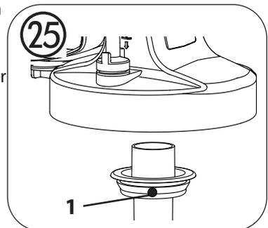
**LET OP!** Reinig nooit afdichtingen, membraan en sproeier- of luchtopeningen van het spuitpistool met spitse metalen voorwerpen. Luchttoevoerslang en membraan zijn slechts beperkt oplosmiddelbestendig. Niet in oplosmiddel leggen, maar alleen afvegen.
